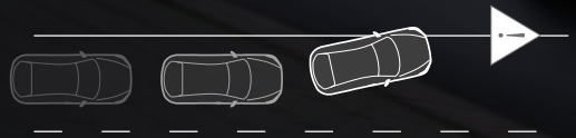
Hệ thống cảnh báo lệch làn đường LDWS (Lane Departure Warning System)
